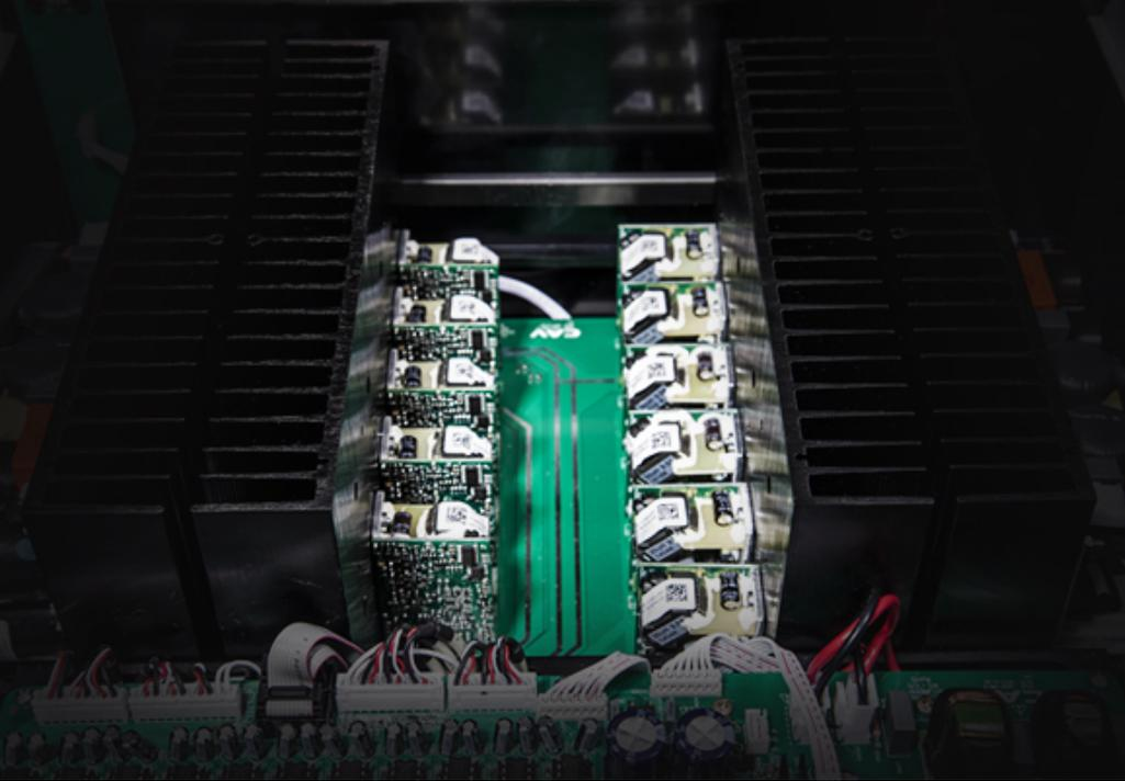
A400每声道有效功率达到160W，采用11声道等功率设计，包含平衡输入和非平衡两种输入方式，可满足杜比全景声功率放大的需求。A400采用荷兰Hypex Electronics 的UCD系列大功率功放模块和美国BB公司为高性能音频系统设计的专用极品运放等元件，具有高性能、高效率、堪称极致完美的环绕声音效。
